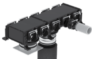
Razdelilnik 10x ComfoTube 75 s spodnjim priklopom in dostopnim območjem spodaj DN160
